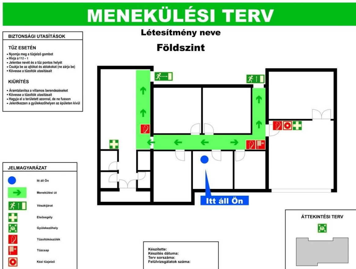
I14.4. ábra: Példa egy irodaépület menekülési tervre. A terv a teljes szintet ábrázolja.
