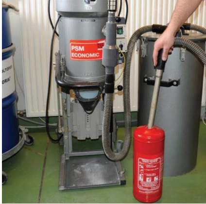
Porkiszívás zártrendszerű berendezéssel
