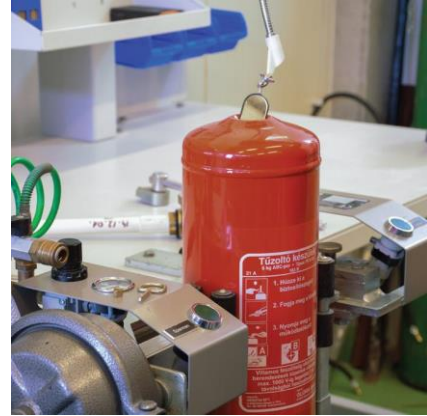
Tartály ellenőrzése tükrös tartályvizsgálóval
