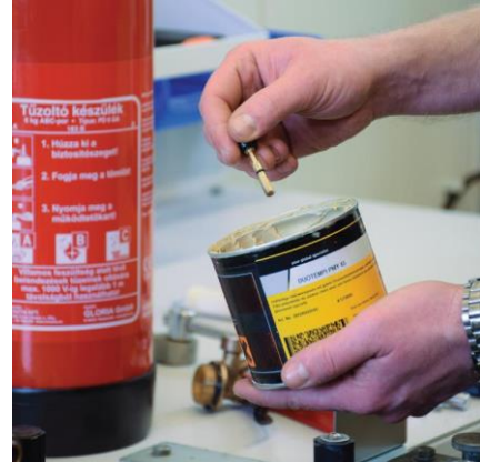
Szelepszár zsírozása, fejszerelvény összeszerelése
