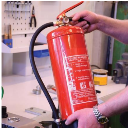
Karbantartott készülék végső szemrevételezése
