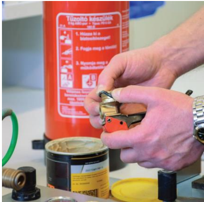
Új O-gyűrű felhelyezése minden karbantartáskor
