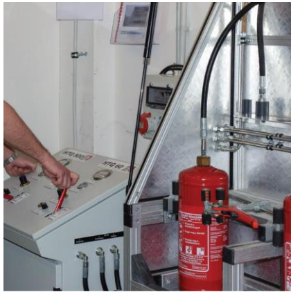
Tartályok nyomáspróbázása (a palástba beütött érték szerint)
