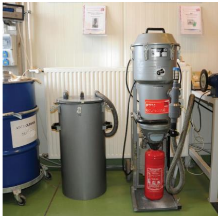
Porvisszatöltés zártrendszerű berendezéssel
