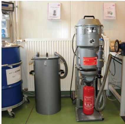
Porvisszatöltés zártrendszerű berendezéssel
