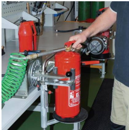
A készüléket nitrogénnel nyomás alá helyezzük
