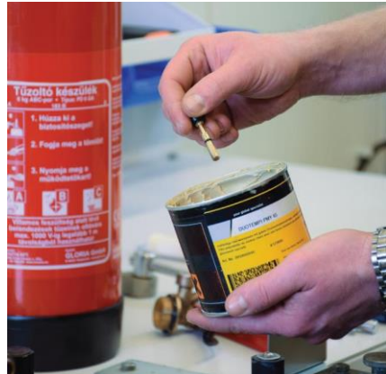
Szelepszár zsírozása, fejszerelvény összeszerelése
