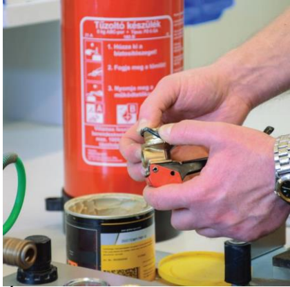
Új O-gyűrű felhelyezése minden karbantartáskor
