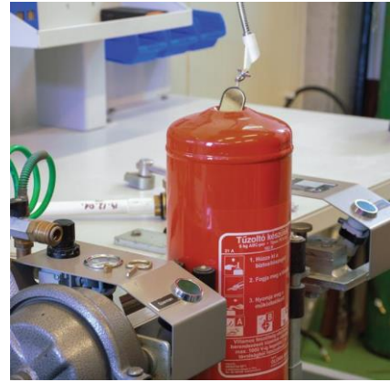
Tartály ellenőrzése tükrös tartályvizsgálóval
