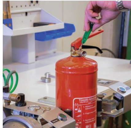
Készülék nyomásmentesítése a szelepbetét eltávolításával
