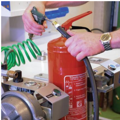
Tömlőszerelvény vizsgálata, kifűtása sűrített levegővel
