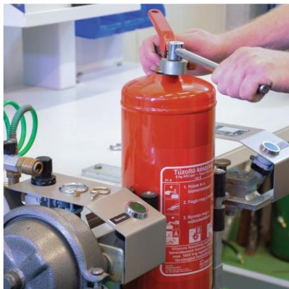
Fejszerelvény kitekerése CSAK NYOMÁSMENTES ÁLLAPOTBAN!
