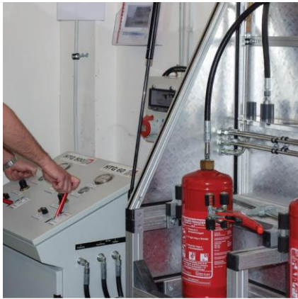
Tartályok nyomáspróbázása (a palástba beütött érték szerint)
