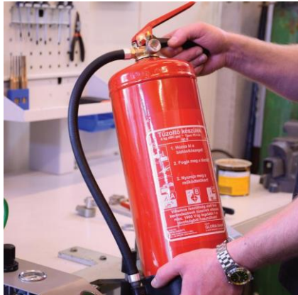
Karbantartott készülék végső szemrevételezése
