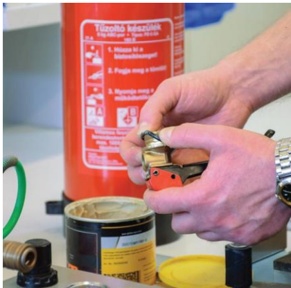
Új O-gyűrű felhelyezése minden karbantartáskor
