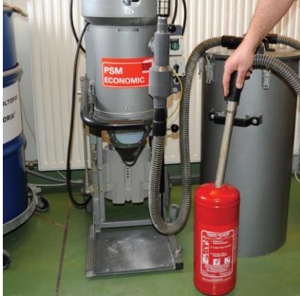
Porkiszívás zártrendszerű berendezéssel
