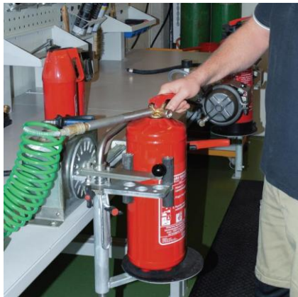
A készüléket nitrogénnel nyomás alá helyezzük
