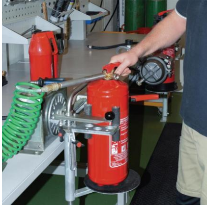
A készüléket nitrogénnel nyomás alá helyezzük
