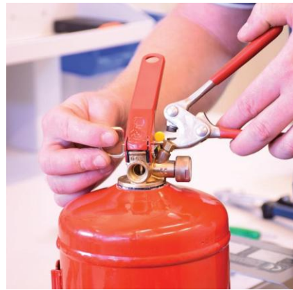
Egyedi azonosítóval ellátott plombafogóval való plombálás, tömlőszerelvény visszaszerelése
