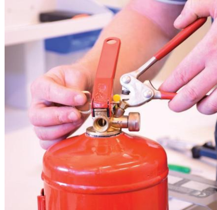
Egyedi azonosítóval ellátott plombafogóval való plombálás, tömlőszerelvény visszaszerelése
