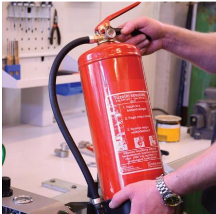
Karbantartott készülék végső szemrevételezése
