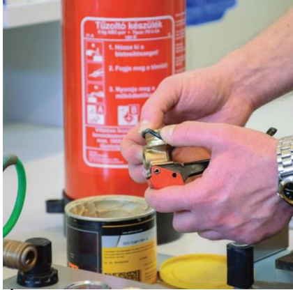
Új O-gyűrű felhelyezése minden karbantartáskor
