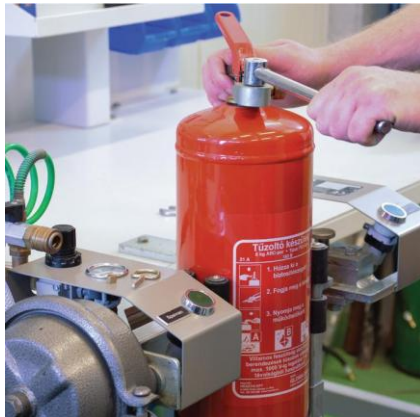
Fejszerelvény kitekerése CSAK NYOMÁSMENTES ÁLLAPOTBAN!
