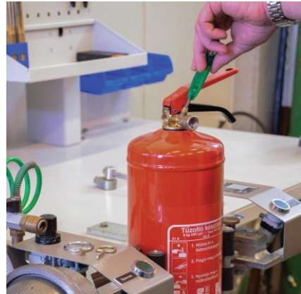
Készülék nyomásmentesítése a szelepbetét eltávolításával
