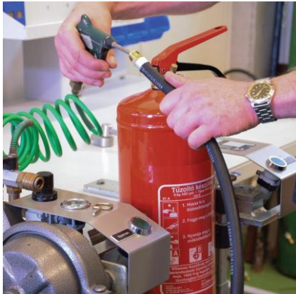
Tömlőszerelvény vizsgálata, kifúvatása sűrített levegővel
