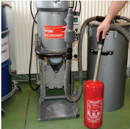
Porkiszívás zártrendszerű berendezéssel
