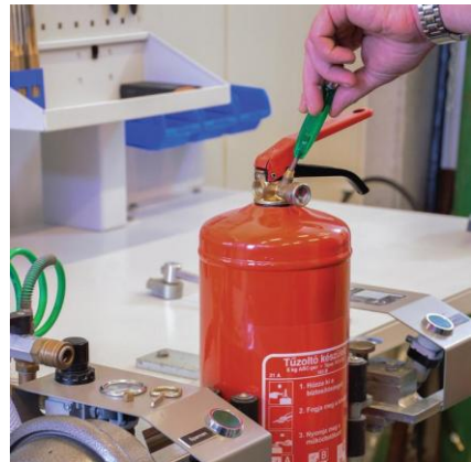
Készülék nyomásmentesítése a szelepbetét eltávolításával
