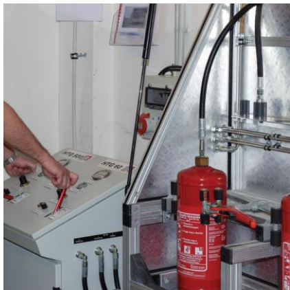
Tartályok nyomáspróbázása (a palástba beütött érték szerint)
