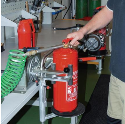
A készüléket nitrogénnel nyomás alá helyezzük
