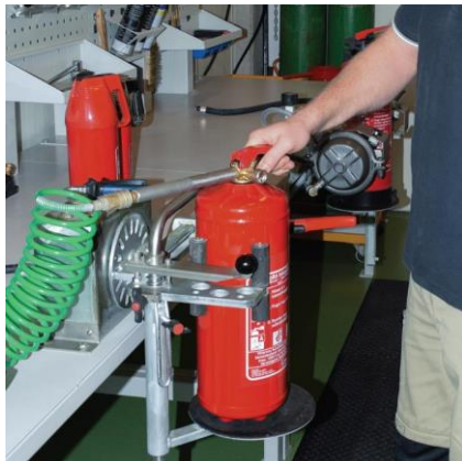
A készüléket nitrogénnel nyomás alá helyezzük
