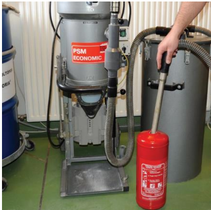
Porkiszívás zártrendszerű berendezéssel
