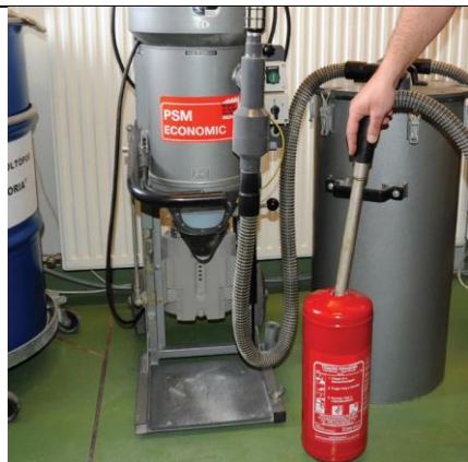
Porkiszívás zártrendszerű berendezéssel
