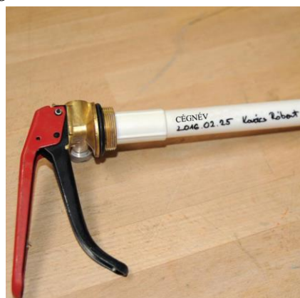
Felszállócső jelölése ( dátum, karbantató szervezet neve vagy azonosító jele, karbantató személy aláírása)
