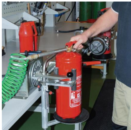
A készüléket nitrogénnel nyomás alá helyezzük
