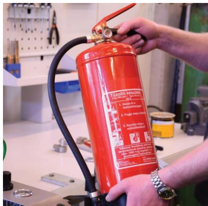
Karbantartott készülék végső szemrevételezése
