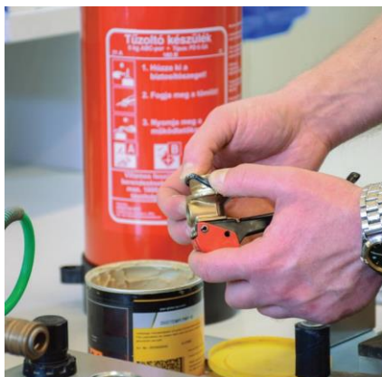
Új O-gyűrű felhelyezése minden karbantartáskor
