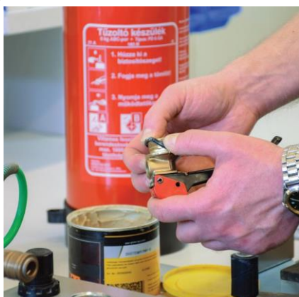
Új O-gyűrű felhelyezése minden karbantartáskor
