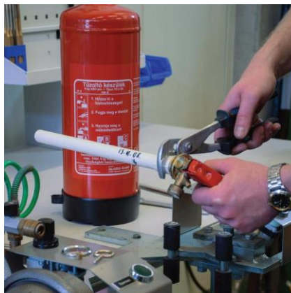
Felszállósó kitekerése a fejszerelvényből
