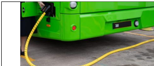
9. ábra példák a kábelvédő spirál alkalmazására
