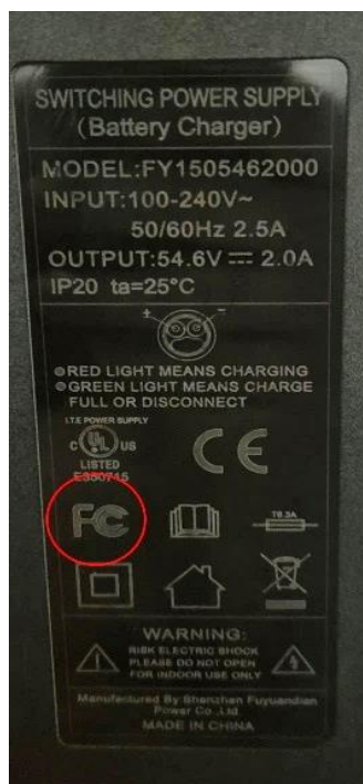
2. ábra: Példa a töltő adattáblájára FCC jelöléssel
