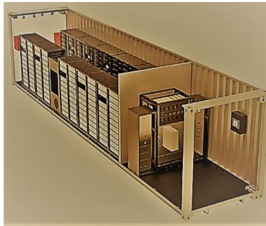
7. ábra: Példa az energiatároló kialakítására kültéren, konténerben
